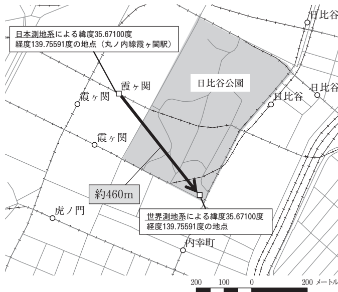
図2 日本測地系と世界測地系の経緯度座標のズレ（例）
